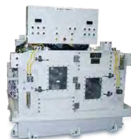
為了滿足客戶對鋼帶表面日益嚴峻的要求，宏樹特別引進2套日本特殊研砥株式會社—NTK 所生產的專業表面研磨機。搭配該公司所生產的各式研磨砥石(UB, FBB)，可以將鋼帶的表面處理成細緻的髮絲紋，且表面粗度可達到 Ra 0.1 μm。
