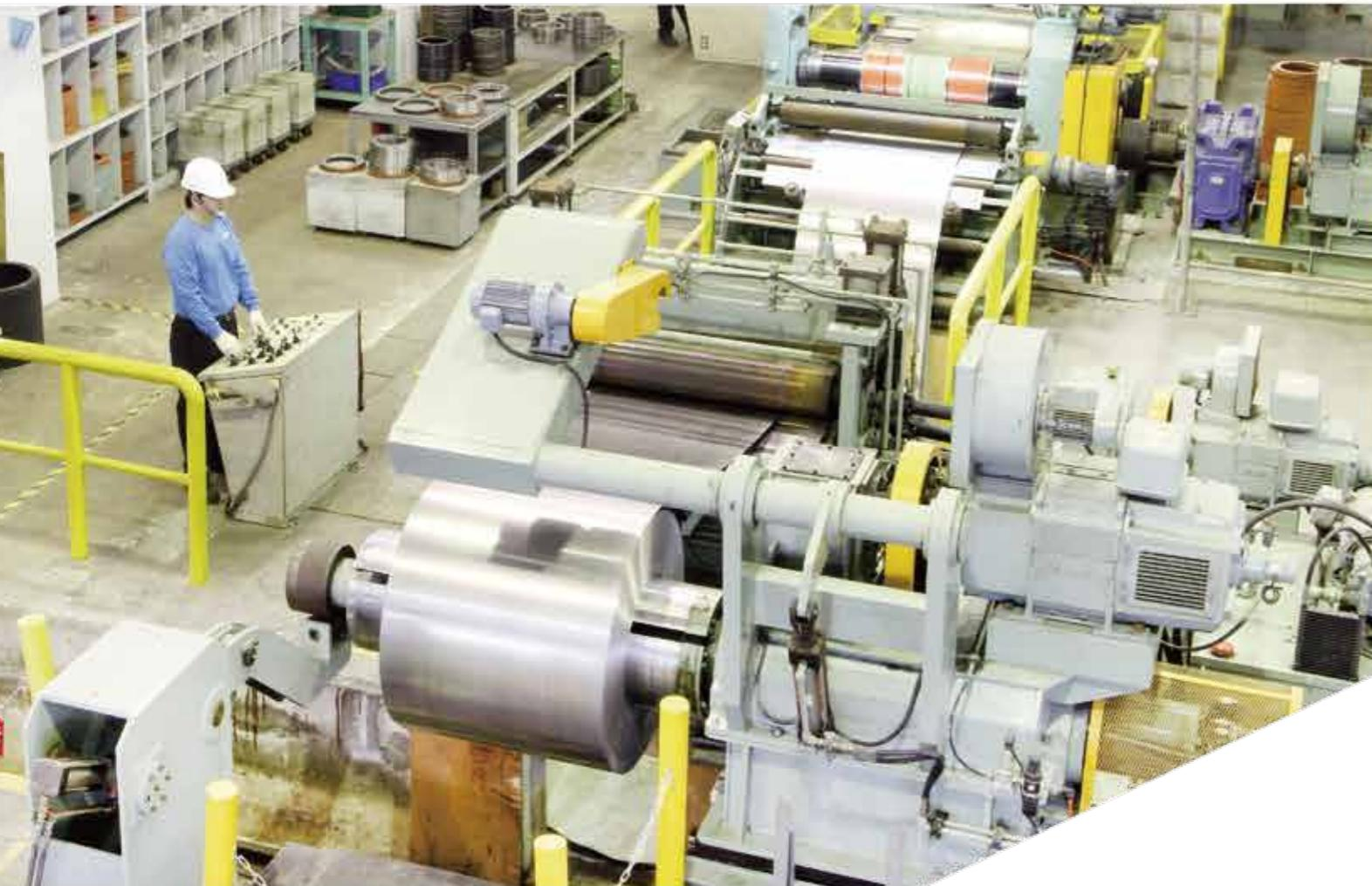
為能全程有效地掌控品質、提昇生產效率並縮短交貨期限，本公司備有日本SONODA公司分條設備。SONODA為全球知名的分條設備供應商，該套設備具優異的操控性與超高精準度。不但裁切的寬度公差達到世界級的標準，且在降低裁切損失方面，也有優異的表現。其最大裁切尺寸可達1,220mm，可提供客戶更多尺寸的選擇。
